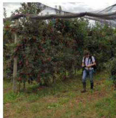
Fig. 3.3.2 - Acquisizione frutteto mediante laser scanner SLAM installato sul backpack
